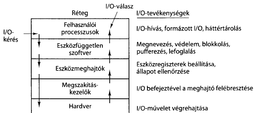
3.8. ábra. Az I/O-rendszer rétegei és az egyes rétegek fő feladatai
