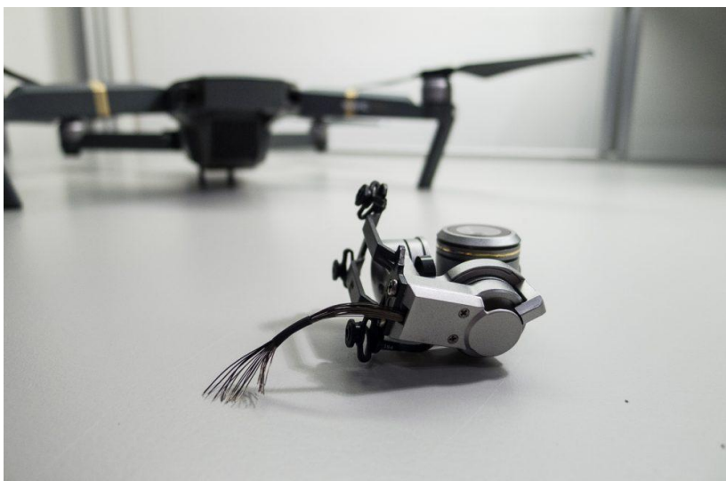
Leszakadt gimbal kamera javítása – fotó: APPSolute
